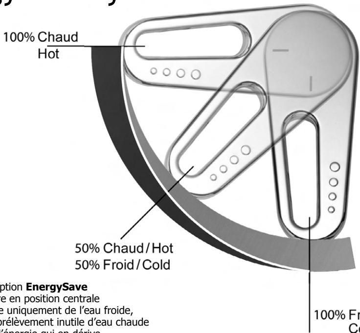
Grâce à la conception **EnergySave**, lors de l'ouverture en position centrale le mitigeur débite uniquement de l'eau froide, évitant ainsi un prélèvement inutile d'eau chaude et le gaspillage d'énergie qui en dérive, au bénéfice d'une économie significative d'énergie. Le réglage de la température se fait normalement en tournant la manette vers la gauche, jusqu'à obtenir la température maximum souhaitée.
